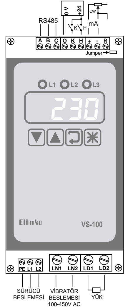
Şekil 2.1. E-VS-100 Ön Panel Görünümü ve Bağlantı klemensleri.
